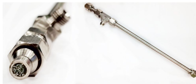
Рис. 1. Модуль для исследования газотранспортных характеристик полуволоконных газоразделительных мембран на основе полиимида.
